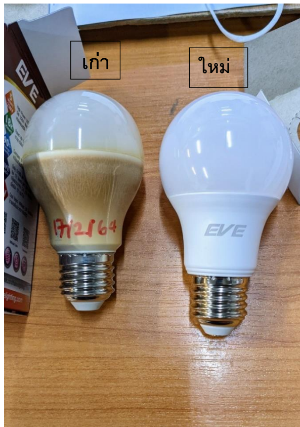
รูปที่ 19 โครงการติดตั้งหลอดไฟแบบ LED ทางเดินส่วนกลางในอาคาร
